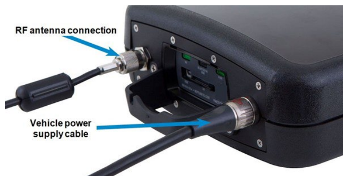
Figura 10 - Cable de alimentación del vehículo
