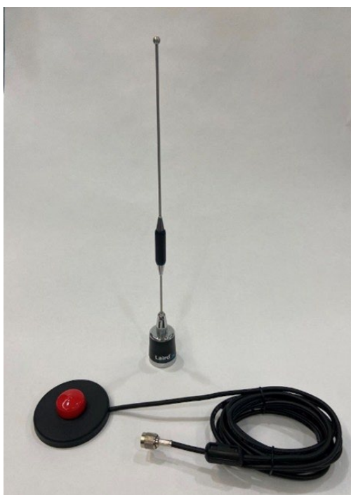
Figura 12 - Antena y cable
